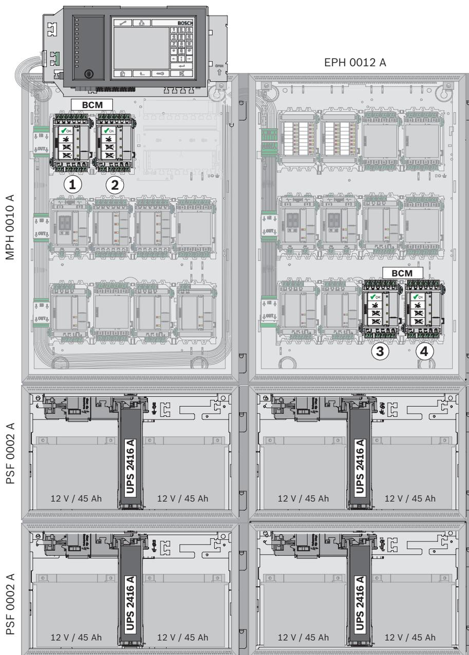
**Abbildung 3.9:** Konfiguration von 1 bis 4 BCM-Modulen (Rahmenmontage)
