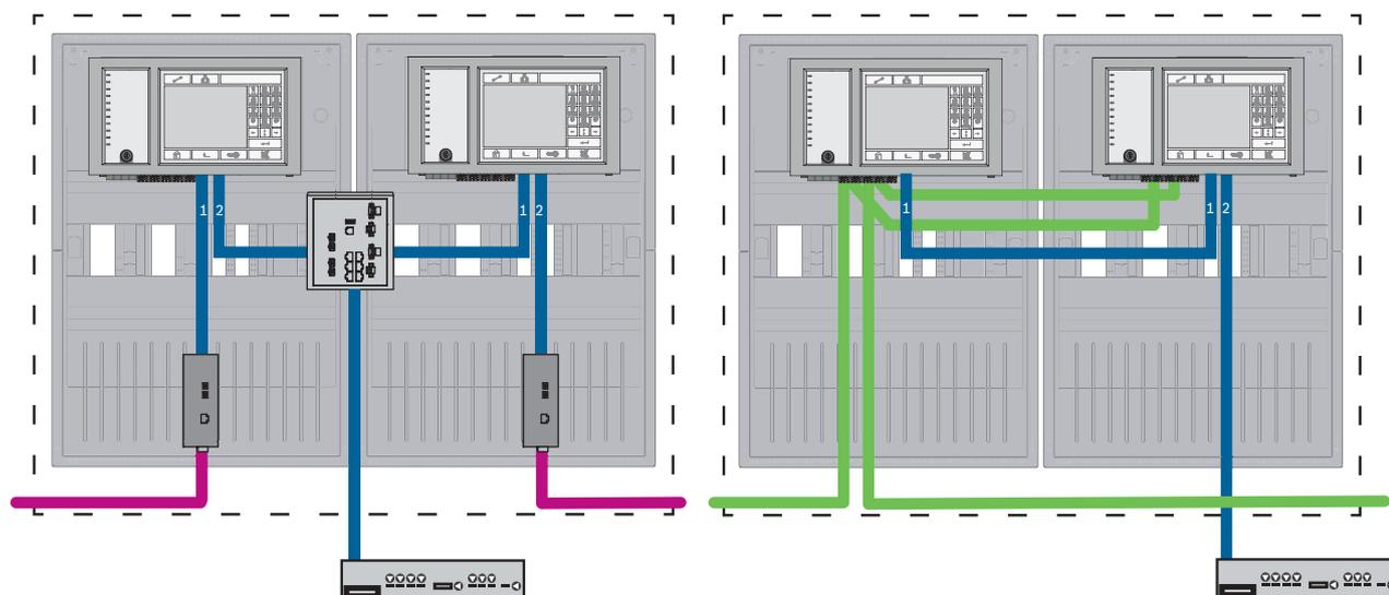
**Figura 7.10:** A sinistra: in rete Ethernet; a destra: in rete CAN
