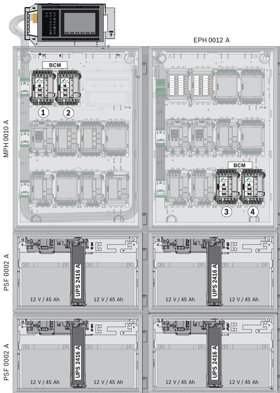
**Abbildung 3.6:** Konfiguration von 1 bis 4 BCM-Modulen (Rahmenmontage)
