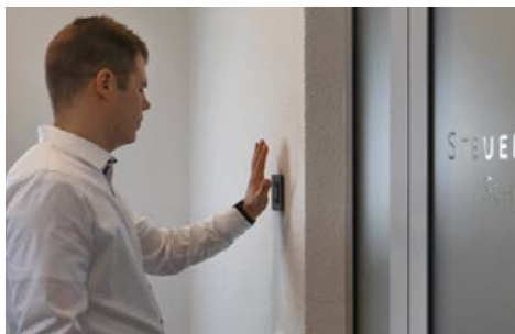
Scanner das veias das palmas das mãos – iCognize Manuscan 2
