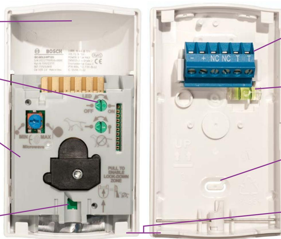
Faixa de terminais removível para porta de elevação para fácil instalação e evita fiação incorreta
