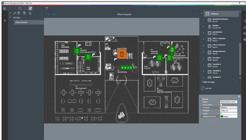
Просмотр карты здания с фактическими поэтажными планами, импортированными в систему. Функция перетаскивания иконок, представляющих двери, считыватели, кнопки выхода/входа, оптические сигнализации, детекторы и т. д.
